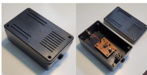
FIGURA 3. Caja de adaptación (lado izquierdo). Aspecto del interior (lado derecho).
